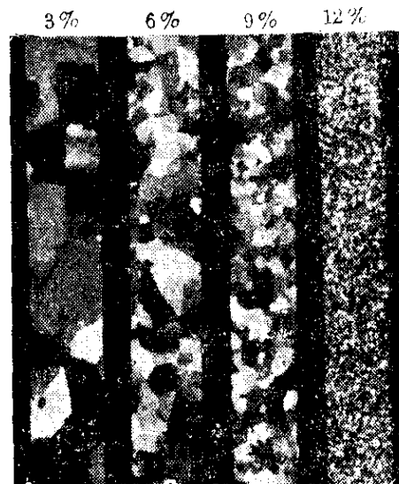
图10-2 变形度对工业纯铝再结晶退火后晶粒大小的影响 1×
