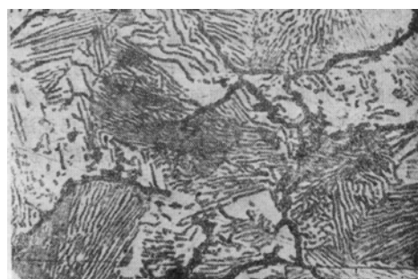
图6-7 T12钢的显微组织 400× (碱性苦味酸钠溶液浸蚀)
