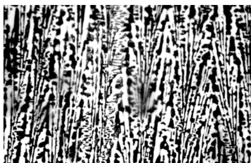
图6-8 共晶白口铸铁的显微组织 400×
