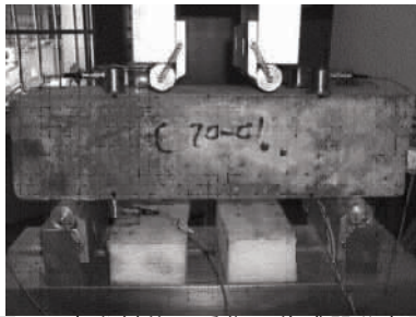
图1 声发射信号采集用传感器分布图
